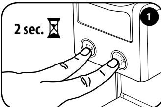
Apague la máquina pulsando simultáneamente durante 2 segundos los dos botones del café ☕️.
