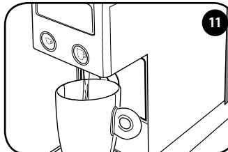
Appuyer sur la touche ☕ ou ☕ et attendre l'arrêt de la distribution d'eau. La machine est rinçée lorsqu'au moins 3 tasses d'eau ont été distribuées. La machine est désormais prête à l'usage.
