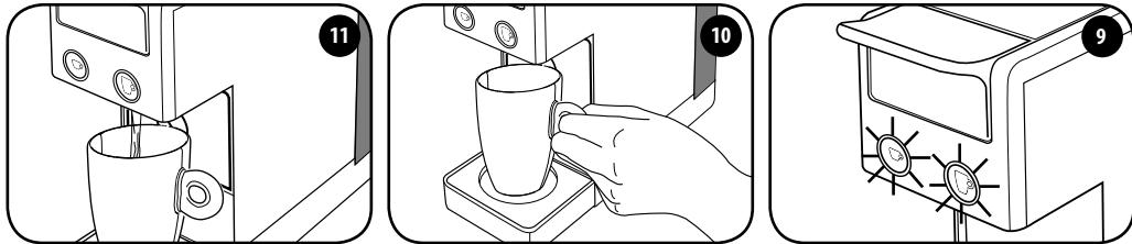
عندما يضيء كل مفتاحي القهوة بشكل ثابت، ضع فنجاناً كبيراً فارغاً تحت نقطة الصب. وظيفة توفير الطاقة تكون الماكينة جاهزة للاستخدام.
