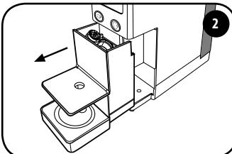
Retire o porta-cápsulas. O porta-cápsulas pode conter no máximo 7 cápsulas, portanto, é aconselhável esvaziá-lo regularmente para evitar que as cápsulas fiquem presas.
