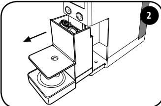
Træk kapselbeholderen ud. Kapselbeholderen kan højst indeholde 7 kapsler og det er derfor hensigtsmæssigt, at tømme den jævnligt, for at undgå at kapslerne fastklemmes.
