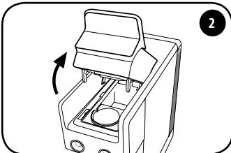
Den Hebel für die Öffnung/Schließung des Kapselfachs langsam (bis zum Anschlag) nach oben schieben.
