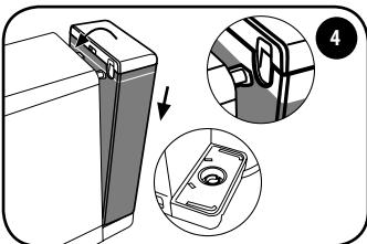
Установите бак напротив двух отверстий и прижмите его к машине до полного соединения.
