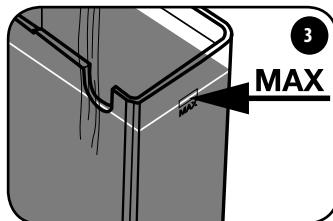
Llene el depósito con agua fresca hasta el nivel máximo.
