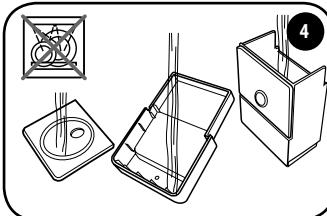
Die Teile unter laufendem Wasser abspülen und abtrocknen. Die verschiedenen Teile nicht in der Spülmaschine waschen.
