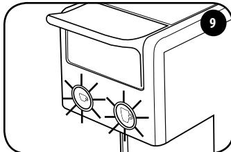
Wanneer de beide koffietoetsen onafgebroken oplichten, is de machine klaar voor gebruik.
