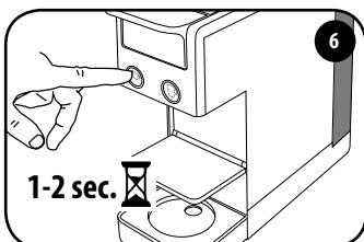
Allumer la machine en appuyant sur l'une des deux touches café pendant 1 à 2 secondes.
