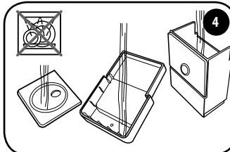
Spoel de onderdelen onder stromend water en droog ze af. Reinig de onderdelen niet in de vaatwasser.
