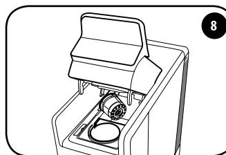
Løft langsomt grebet, for at udstøde den brugte kapsel. Kapslen opsamles automatisk i den relevante beholder. Gentag handlingen, hvis kapslen ikke udstødes.
