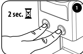
Schakel het apparaat uit door de twee toetsen voor de afgifte van koffie ☕️ tegelijkertijd 2 seconden ingedrukt te houden.
