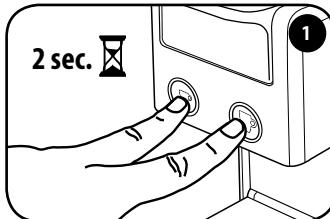
Выключите машину, нажав одновременно на 2 сек. две кнопки подачи кофе ☕.
