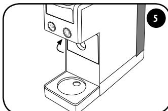
Den Tassenabstellrost in die vertikale Position bringen. Den Wassertank mit frischem Trinkwasser füllen.
