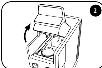
Soulever lentement (jusqu'à l'arrêt) le levier d'ouverture/fermeture du compartiment à capsules.
