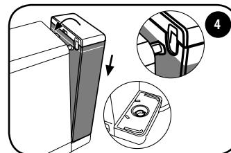
Vuelva a introducir el depósito en las dos ranuras y guíelo hacia la máquina hasta que esté completamente encajado.
