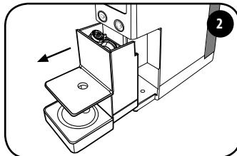
Извлеките держатель капсул. Держатель капсул может вмещать максимум 7 капсул, следовательно, необходимо регулярно опорожнять его, чтобы избежать застревания капсул.
