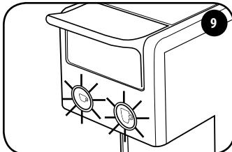
Cuando los dos botones del café se iluminan con luz fija significa que la máquina está lista para el uso.
