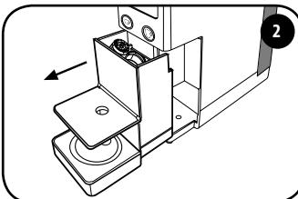
Extraiga el portacápsulas. El portacápsulas puede contener como máximo 7 cápsulas, así que vacíelo periódicamente para que no se atasquen las cápsulas.
