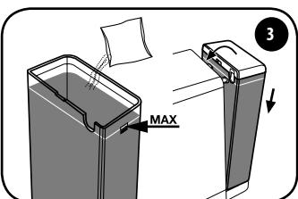
Encha o reservatório com água fresca até o nível máximo e dissolva a solução descalcificante.
