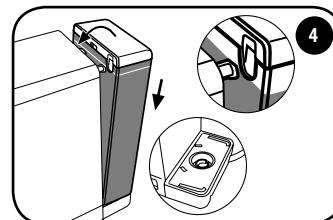
Remettre le réservoir en place au niveau des deux fentes et l'accompagner vers la machine jusqu'à l'accrochage complet.
