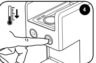
咖啡胶囊舱门打开时，通过按住两个咖啡冲泡按键之一 1-2 秒启动机器。
