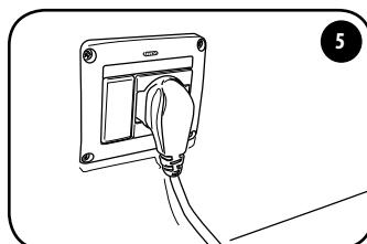
Sluit het apparaat aan op het stopcontact.
