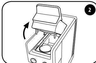
Levante lentamente (hasta el tope) la palanca de apertura y cierre del compartimiento de las cápsulas.
