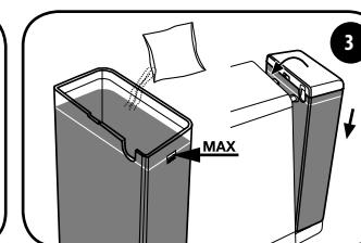
Llene el depósito con agua fresca hasta el nivel máximo y disuelva la solución descalcificadora.
