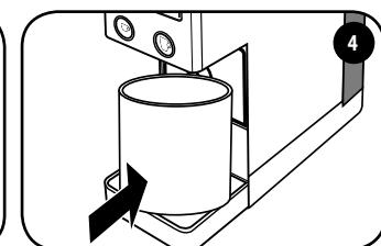
Coloque un recipiente de al menos 0,75 litros debajo del tubo de salida.
