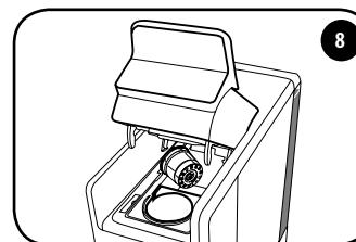
Per espellere la capsula usata alzare lentamente la leva e la capsula verrà automaticamente raccolta nell'apposito contenitore. Se la capsula non viene espulsa ripetere l'operazione.
