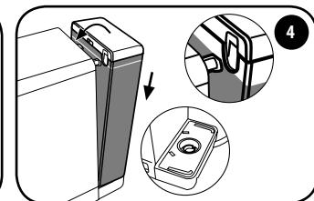
Den Tank wieder in die beiden Schlitze einsetzen und in die Maschine führen, bis er komplett einrastet.
