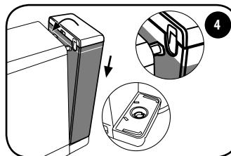
Sæt tanken i igen udfør for de to åbninger og skub den mod maskinen indtil den fuldstændigt sidder fast.
