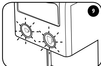
По завершении цикла ополаскивания кнопка и кнопка мигают одновременно.
