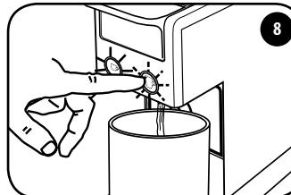
Coloque un recipiente de al menos 0,75 litros debajo del tubo de salida.
