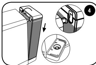
重新装上含除垢剂的水箱,操作方式为:对齐两个槽口,朝着机器移送,直到准确钩接。
