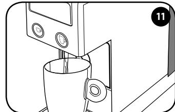
Druk op een toets ☑ of ☒ en wacht tot er geen water meer uit het apparaat stroomt. Het apparaat is goed gespoeld als er minstens 3 koppen water zijn afgegeven. Het apparaat is nu klaar voor gebruik.
