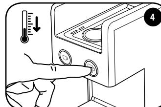
Bei geöffnetem Hebel die Maschine einschalten, indem man eine der beiden Kaffeeausgabestasten 1-2 Sekunden lang drückt.
